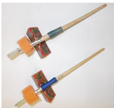
Рис. 3. Насадка на кисточку из поролона, против подтекания клея и краски.
